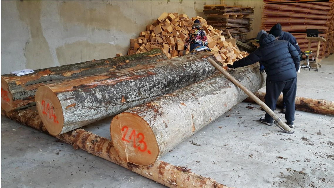
25-09-3 Bukovina: Slika 3: Vizualno razvrščanje hlobov na GG Novo mesto
